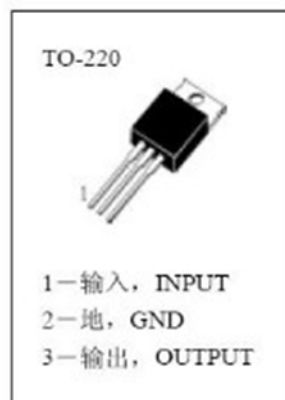
图 1.8 TO-220 引脚定义
